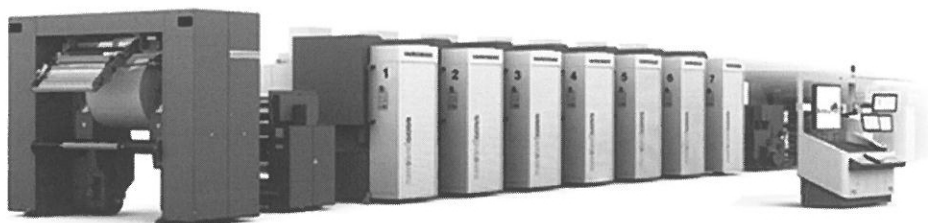
ウェブオフセット輪転機「VARIOMAN」。フィルムと紙の両方のパッケージング印刷に対応
